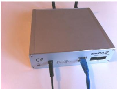
Optionnellement, raccorder au réseau RNIS par un ou deux câbles RNIS BRI sur le ou les ports BRI (port 1, 2 ici).
